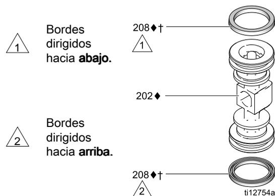
4. Engrase ambos extremos del pistón (202◆) y el orificio de la carcasa. Instale el pistón en la carcasa (201) con la parte plana hacia la copa (213◆). Tenga cuidado de no romper las copas en U (208◆†) cuando deslice el pistón en la carcasa.
