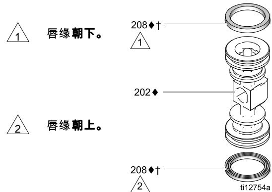
4. 润滑活塞 (202◆) 两端和壳体孔。将活塞安装到壳体 (201) 内，扁平一侧朝向杯体 (213◆)。将活塞推入壳体时，务必要小心，不要撕破 U 形杯 (208◆†)。
