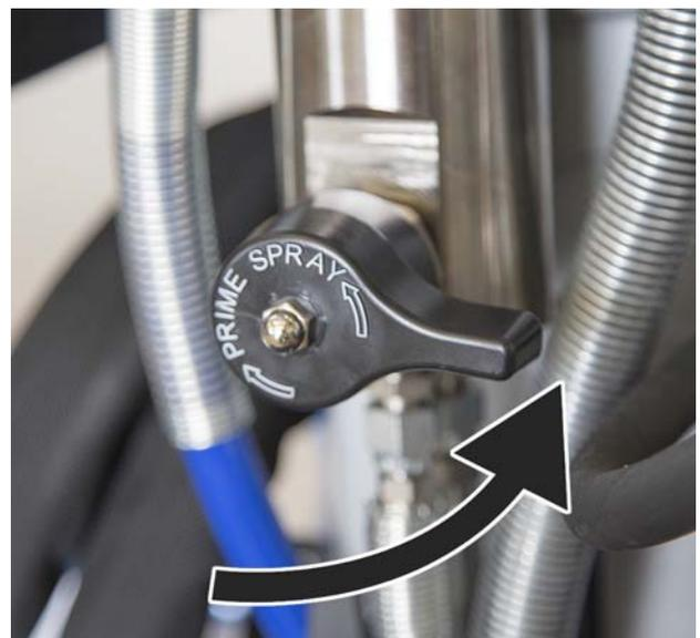
12. Das Hydraulikventil (E) öffnen und so einen Druck des Harzes (MMA) aufbauen (2000-2500psi).
