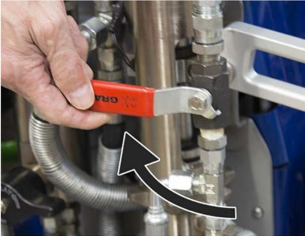
2. Hydraulikventil an der Lösungsmittelpumpe öffnen.
