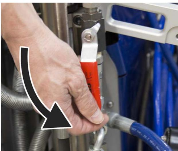
13. Den Materialzufuhrhebel (B) am Mischverteiler öffnen.
