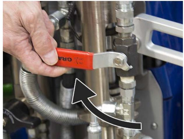
11. Das Harz (MMA)-Spritz-/Entlüftungsventil (C) in Stellung SPRAY (SPRITZEN) stellen.
