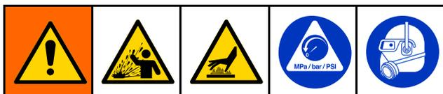
Это оборудование остается под давлением до тех пор, пока давление не будет сброшено вручную. Во избежание получения серьезной травмы жидкостью под давлением, например, в результате разбрызгивания жидкости, выполняйте процедуру сброса давления после завершения дозирования и перед очисткой, проверкой либо обслуживанием оборудования.
