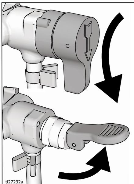
20. Okrenite sklopku za uključivanje/isključivanje u položaj **OFF** (Isključeno).
