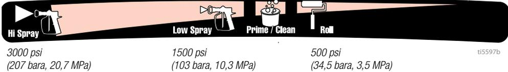
Ako želite odabrati funkciju, poravnajte simbol na gumbu za regulaciju tlaka s indikatorom podešenosti na raspršivaču.
