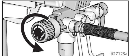
7. Pri prvom raspakiranju raspršivača uklonite materijal od ambalaže iz ulaznog sita. Nakon dugotrajnog skladištenja provjerite da na ulaznom situ nema začepljenosti ili otpada.
