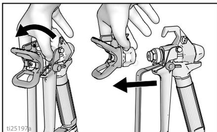
3. Uklonite usisnu cijev i cijev za pražnjenje iz boje, obrišite ostatak boje izvana.
