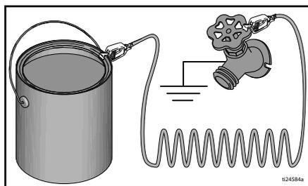
**Kako biste održali kontinuitet uzemljenja tijekom ispiranja ili otpuštanja tlaka:** čvrsto držite metalni dio pištolja za raspršivanje uz stjenku uzemljene posude i zatim aktivirajte pištolj.
