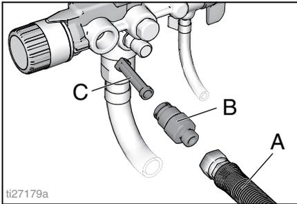
5. Provjerite da u filtru tekućine InstaClean (C) nema otpada. Ako je potrebno, filtar operite vodom ili otapalom za ispiranje i mekom četkom.
