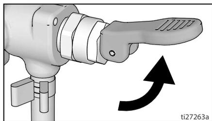
15. Okrenite sklopku za uključivanje/isključivanje u položaj **OFF** (Isključeno).
