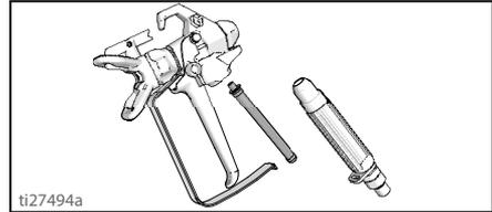
2. Uklonite mlaznicu za raspršivanje i sklop štitnika mlaznice te ih očistite vodom ili tekućinom za ispiranje i iščetkajte.
