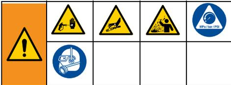
Ova oprema ostaje pod tlakom dok se tlak ručno ne otpusti. Kako bi spriječili teške ozljede od tekućine pod tlakom, poput infekcije kože, prskanja tekućinom i pokretnih dijelova, slijedite **postupak za ispuštanje tlaka** svaki puta kada se raspršivač zaustavi i prije čišćenja ili provjere te prije servisiranja opreme.
