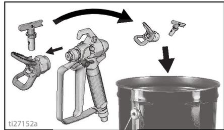
3. S vanjske strane pištolja boju obrišite pomoću meke krpe natopljene vodom ili tekućinom za ispiranje.
