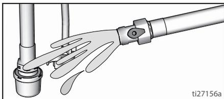
9. Odvrnite ulazno sito od usisne cijevi. Stavite usisno sito i isperite ga u posudu s otpadnom tekućinom.
