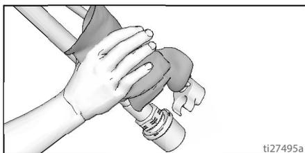
4. Odvojite cijev za pražnjenje (manja) od usisne cijevi (veća).
