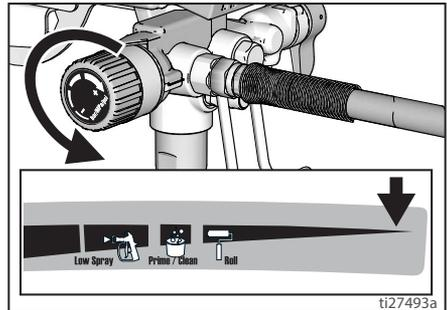
4. Stavite cijev za ispuštanje i vjedro i ventil za punjenje/raspršivanje postavite u položaj **PRIME** (punjenje) kako biste isпустили tlak.
