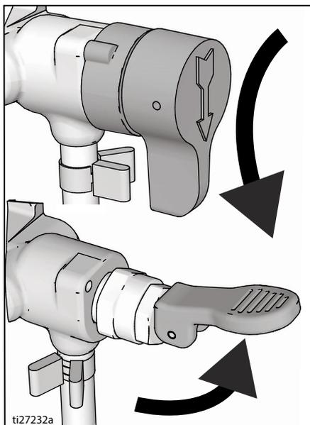
5. Okrenite prekidač za uključivanje/isključivanje u položaj **ON** (Uključeno).
