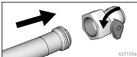
8. Otvorite dovod vode. Otvorite ventil. Isperite boju iz usisnog crijeva, ispraznite cijevi i ulazno sito i zatim zatvorite ventil.
