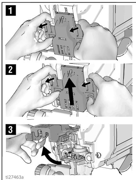
3. Svucite sklop pumpe sa zatika za montažu.
