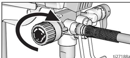
7. Kada tekućina za skladištenje počne izlaziti iz cijevi za ispuštanje (5-10 sekundi) sklopku za uključivanje/isključivanje okrenite u položaj **OFF** (Isključeno).
