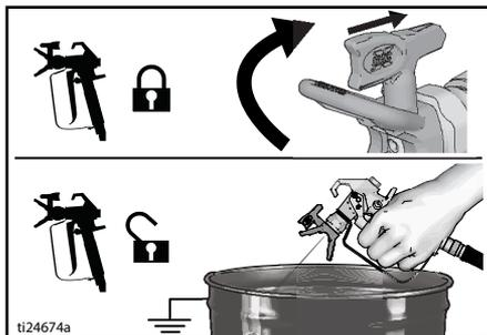
2. Aktivirajte blokadu otklonca. Okrenite mlaznicu za raspršivanje natrag u položaj za raspršivanje. Otpustite blokadu otklonca i nastavite prskati.
