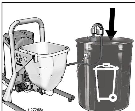
6. Nalijte tekućinu za ispiranje u lijevak. Za boju na bazi vode koristite vodu, a mineralni alkohol za uljanu boju.
