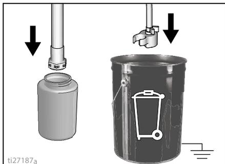
3. Na modelima s lijevkom postavite usisnu cijev u bocu s tekućinom Pump Armor, a cijev za ispuštanje u posudu za otpadnu tekućinu.
