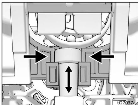
3. Zaokrenite pumpu vrata za brzi pristup i gurajte cijeli sklop vrata prema strani pumpe s ulaznim ventilom.
