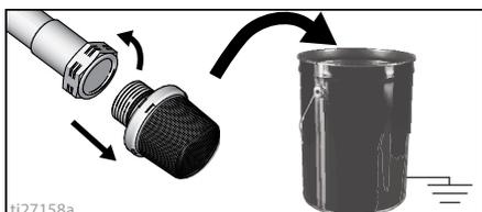
10. Ligue a mangueira de jardim ao tubo de sucção com a válvula do acessório Power Flush. Deixe o tubo de drenagem num balde de resíduos.
