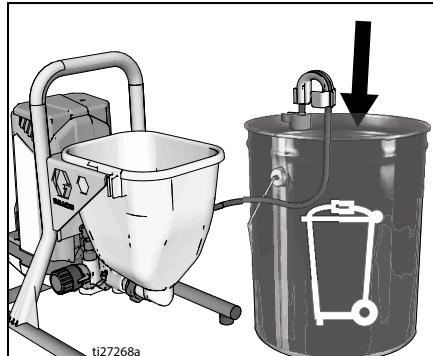
6. 洗浄液をホッパーに流し込みます。水性塗料の場合には水を、油性塗料の場合にはミネラルスピリットを使用します。
