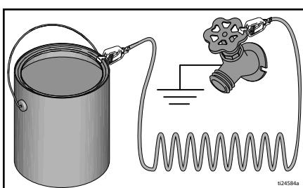
**スプレーヤーの洗浄または圧力開放時に接地の導通性を確保するためには、** 接地された金属のペール缶の側面にスプレーガンの金属部分をしっかりと当てながらガンの引き金を引きます。
