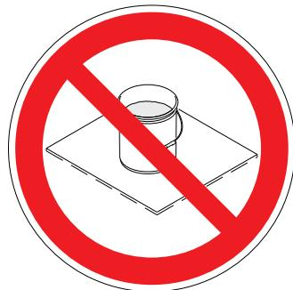
**金属ペール缶は必ず接地してください:** 接地線をペール缶に接続してください。一方の端はペール缶にクランプし、他方の端は水管などの正しい接地にクランプします。
