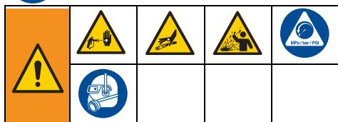
本装置は、圧力が手動で解放されるまでは、加圧状態が続きます。皮膚への侵入、硫体の拡散、など、高压硫体による深刻な損傷を受けないようにするには、スプレーヤーが停止した場合は常に、またスプレーヤーの洗浄または点検を行う前に、および装置のメンテナンスを行う前に**圧力開放手順**に従ってください。
