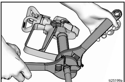
3. レンチを使用してしっかりと締め付けます。ホースが既に接続されている場合は、しっかりと締め付けられていることを確認してください。
