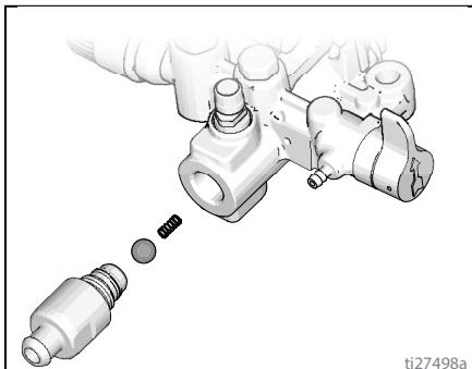
3. 異物や乾燥して固まった塗料をキャビティからすべて取り除き、ボールとスプリングを取り替えます。フレームの統合ツールを使用して、インレットバルブをポンプに取り付けて絞めます。
