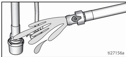
9. インレットストレーナーを回して吸引チューブから取り外します。インレットストレーナーを廃液ペール缶に入れます。
