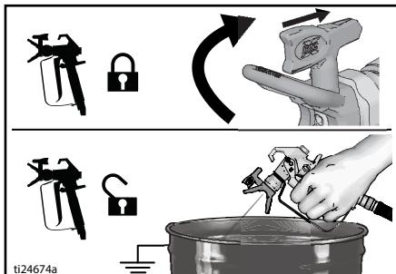
2. 引き金ロックを掛けます。スプレー・チップを回してスプレーの位置に戻します。引き金ロックを解除してスプレーを続行します。
