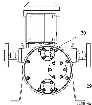
Figure 1 Сливное отверстие (29) и вентиляционное отверстие (30) насоса
