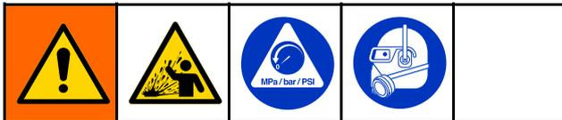
Cet équipement reste sous pression tant que celle-ci n'est pas relâchée manuellement. Pour éviter de sérieuses blessures provoquées par du liquide sous pression, comme des éclaboussures dans les yeux ou sur la peau, exécuter la procédure de décompression lorsque le pompage est arrêté et avant un nettoyage, une vérification ou un entretien de l'équipement.
