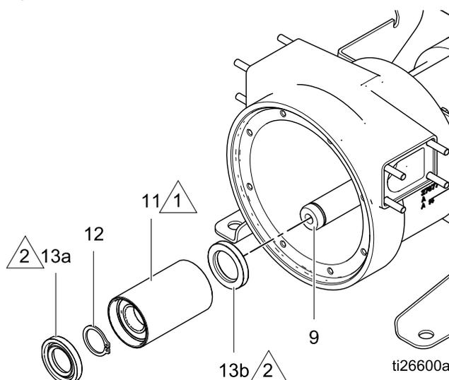
Figure 3 Retirer ou monter le rouleau
