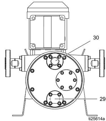
Figure 1 Vanne de vidange pompe (29) et ventilation (30).
