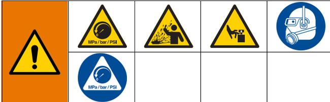
Cet équipement reste sous pression jusqu'à ce que la pression soit libérée manuellement. Pour éviter de sérieuses blessures provoquées par des éclaboussures de fluide et des pièces en mouvement, exécutez la Procédure de décompression lorsque vous arrêtez la pulvérisation et avant un nettoyage, une vérification ou un entretien de l'équipement.
