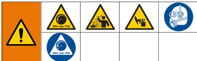
本装置は、圧力が手動で開放されるまでは、加圧状態が続きます。液体の飛散、および可動部品から生じる重大な怪我を避けるには、スプレー停止後と装置を清掃、点検、および整備する前に、圧力開放に従ってください。
