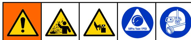
L'apparecchiatura rimane pressurizzata finché la pressione non viene scaricata manualmente. Per evitare gravi lesioni causate da schizzi di fluido e da parti in movimento, attenersi alla procedura di rilascio pressione al termine della spruzzatura e prima di pulire, controllare o riparare l'apparecchiatura.
