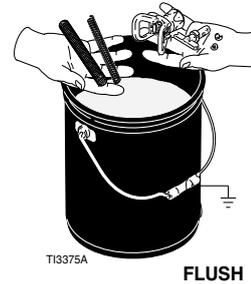
5. 将吸料管套件放入盛有冲洗液的接地金属桶内。将接地线真正接地。执行启动步骤 10 - 16（请参见第 12 页）将喷涂机内的涂料冲洗掉。用水冲洗水性涂料，用矿物油精溶剂（也被称为白涂料）冲洗油性涂料。
