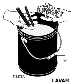
5. Coloque o tubo de sifão dentro de um balde metálico com ligação à massa, parcialmente cheio com líquido de lavagem. Prenda o fio de ligação à terra a um bom ponto de terra. Efetue os passos de Colocação em serviço 10 - 16 (consulte a página 10) para lavar a tinta do pulverizador. Utilize água para eliminar tintas à base de água e aguarrás para tintas à base de óleo.
