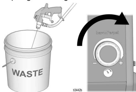
18. Alle Anschlüsse auf Dichtheit überprüfen. Wenn undichte Stellen auftreten, das Spritzgerät sofort abschalten. Führen Sie eine **Druckentlastung** durch. Undichte Fittings festziehen. Schritte 1 – 17 im Kapitel **Inbetriebnahme** wiederholen. Wenn keine undichten Stellen vorhanden sind, die Pistole weiterhin betätigen, bis das System gründlich gespült ist. Mit Schritt 18 fortfahren.
