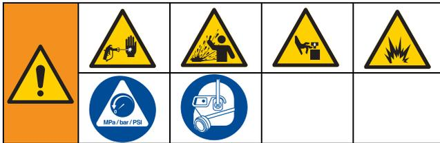
Dieses Gerät bleibt unter Druck, bis der Druck manuell entlastet wird. Zu Vermeidung von ernsthaften Verletzungen durch Kontakt mit unter Druck stehenden Flüssigkeiten oder beweglichen Teilen sind nach Abschluss des Spritzvorgangs sowie vor Reinigung, Prüfung oder Wartung des Geräts die Schritte zur Druckentlastung durchzuführen.
