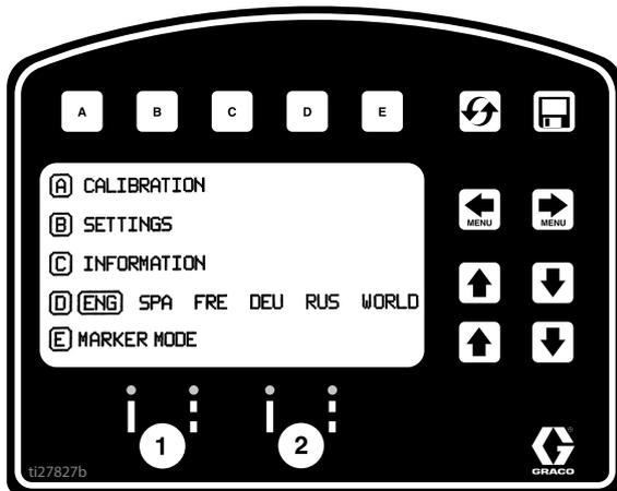
4. Premere **A** per la calibrazione. Impostare DIST CORSA su un valore pari o superiore a 7,6 m (25 ft). Distanze superiori assicurano una migliore precisione, in base alle condizioni.
