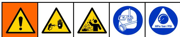
Cet équipement reste sous pression tant que la pression n'a pas été relâchée manuellement. Pour éviter de sérieuses blessures provoquées par du produit sous pression, comme des injections sous-cutanées et des projections de produit, exécutez la **Procédure de décompression** lorsque vous arrêtez la pulvérisation et avant un nettoyage, une vérification ou un entretien de l'équipement.
