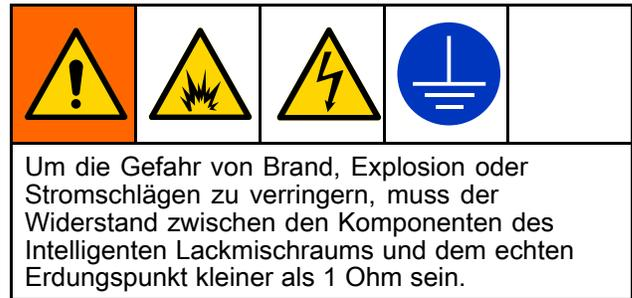
Den Widerstand zwischen Komponente des Intelligenten Lackmischraum und echtem Erdungspunkt prüfen. Wenn der Widerstand 1 Ohm oder mehr beträgt, kann unter Umständen ein anderer Erdungspunkt notwendig sein. Das System darf erst verwendet werden, wenn das Problem behoben ist.
