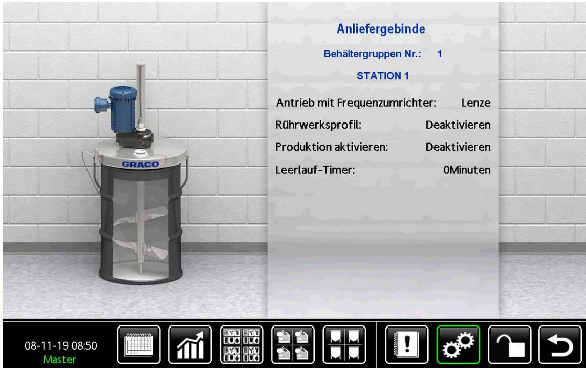
Figure 73 Bildschirm Sekundärrührwerk
