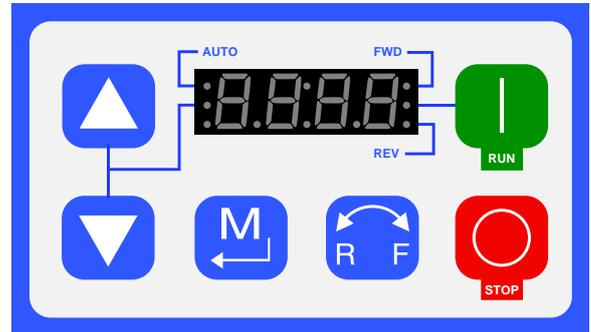
Figure 11 Panneau de commandes de VFD
