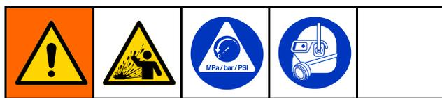
L'apparecchiatura rimane pressurizzata finché la pressione non viene scaricata manualmente. Per evitare gravi lesioni causate dal fluido pressurizzato, ad esempio spruzzi negli occhi o sulla pelle, seguire la procedura di scarico della pressione quando si smette di pompare e prima di pulire, verificare o eseguire la manutenzione dell'apparecchiatura.
