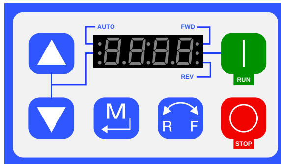
Figure 11 VFD 控制面板
