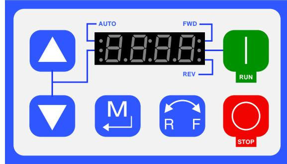
Figure 11 VFD 제어 패널
