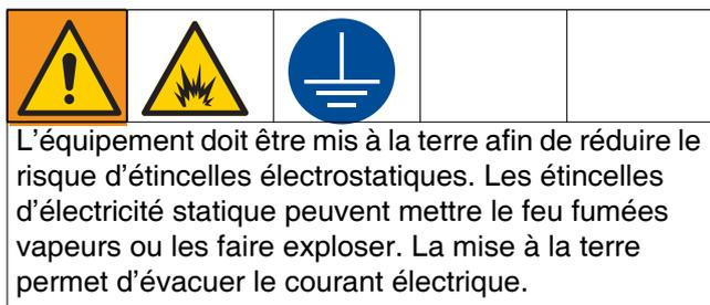
**Pompe :** Utilisez le fil de terre et le collier (fournis). Vérifiez que la vis de mise à la terre (GS) est correctement fixée et serrée sur le moteur pneumatique. Raccordez le collier (U) du câble de mise à la terre statique (HH) à une véritable prise de terre. Pour un fil de terre et un collier de rechange, commandez la pièce 244524.
