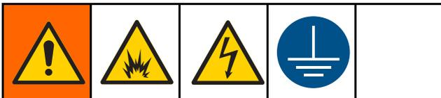
Beim Betrieb der Elektrostatik-Glocke können sich alle ungeerdeten Objekte im Spritzbereich (Menschen, Behälter, Werkzeuge usw.) elektrisch aufladen. Eine unsachgemäße Erdung kann zu Statikfunken führen, die Brände, Explosionen oder Elektroschocks verursachen können. Geräte, Personal, Werkstücke und elektrisch leitfähige Gegenstände im Spritzbereich oder in der Nähe davon erden. Die unten stehenden Erdungsanweisungen beachten.
