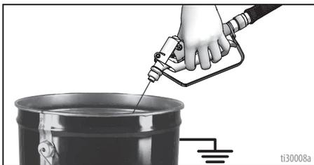
7. Ruotare la valvola di adescamento sulla posizione di **SCARICO** e permettere al fluido di lavaggio di circolare fino a che il fluido stesso non diventa pulito.
