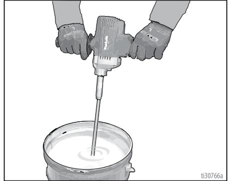
3. Accertarsi che tutti i grumi di polvere secca vengano miscelati accuratamente prima di versare la miscela nel serbatoio dello spruzzatore.
