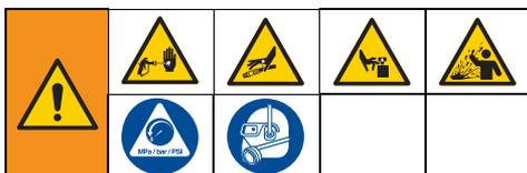
L'apparecchiatura rimane pressurizzata finché la pressione non viene scaricata manualmente. Per evitare gravi lesioni causate dal fluido pressurizzato, come iniezioni nella pelle, dagli spruzzi di fluido e dalle parti in movimento, seguire la **Procedura di scarico della pressione** quando si arresta lo spruzzatore e prima di pulire, verificare o eseguire la manutenzione dell'apparecchiatura.
