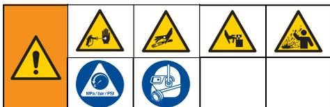
在手动泄压之前，此设备都保持着有压状态。为防止带压液体造成严重伤害，例如皮肤注射、液体溅出及零配件移动，喷涂机处于停止状态和清洁或检查喷涂机以及设备维修前，请遵循以下泄压步骤。
