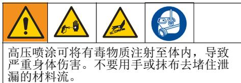
8. 检查是否有泄漏。如有泄漏，执行 **泄压步骤**，页 10。紧固接头。执行 **启动** 中的步骤 2 - 6。若无泄漏，继续操作 **向泵中填料**，页 14。
