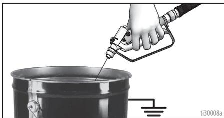
7. 将填料阀旋转至泄流位置以循环冲洗流体，直到出现洁净的冲洗流体。
