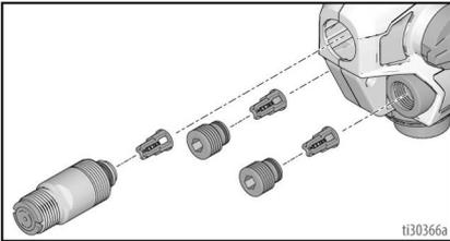
4. Почистете възлите на изпускателния клапан с топла вода или минерален спирт.
