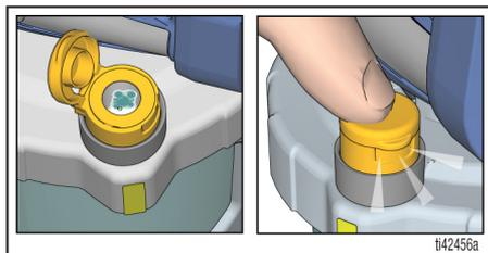
3. Завъртете копчето за заливане напред в позиция SPRAY (пръскане). Проверете дали дюзата е напред на позиция SPRAY (пръскане).
