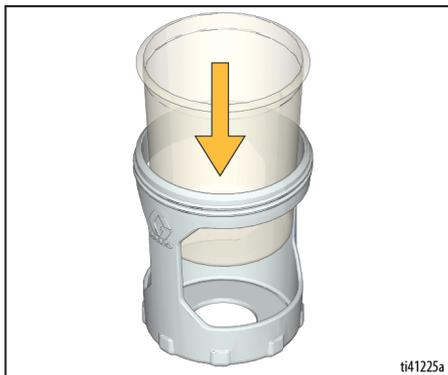
2. Здраво затегнете капака на резервоара към опората на резервоара, за да постигнете херметично уплътняване.
