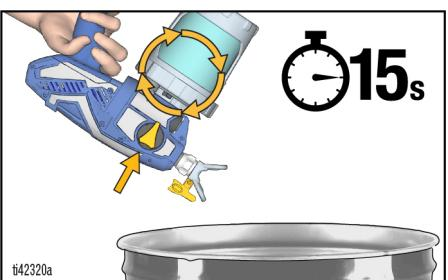
5. Za raspršivanje tekućine za čišćenje, ponovno ispunite sklop čiste čašice tekućinom za čišćenje i ponovno je pričvrstite na raspršivač.
