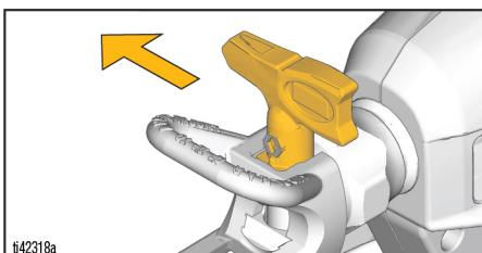
4. Provjerite je li raspršivač potpuno zatvoren. Uvjerite se da je VacuValve zatvoren i da je čašica pričvršćena na raspršivač, a zrak je posve ispušten.
