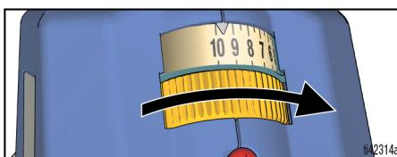
4. Okrenite raspršivač u kantu za otpad, gumb za punjenje okrenite prema naprijed, u položaj za raspršivanje (SPRAY). Izvucite okidač na 5 sekundi kako biste odstranili začepljene.
