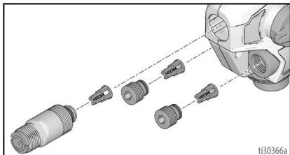
4. Očistite sklopove izlaznih ventila topлом vodom ili prirodnim alkoholom.
