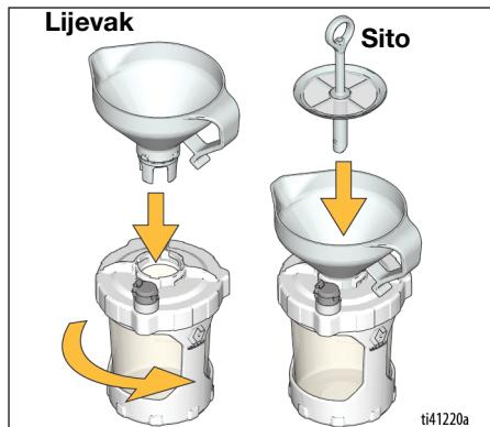
4. Cijev za zrak cijediljke sprječava prekomjerno punjenje čašice bojom. Čašicu napunite na sljedeći način:
