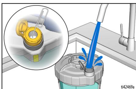
**NAPOMENA:** Obavezno očistite unutrašnjost spremnika VacuValve. Ako se rupa na VacuValve začepi, očistite rupu spajalicom za papir.
