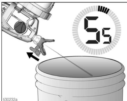
12. Αν χρησιμοποιήθηκε δεύτερο μπεκ ψεκασμού, αφαιρέστε το καθαρισμένο μπεκ ψεκασμού και τοποθετήστε το δεύτερο μπεκ ψεκασμού. **Βλ. Εγκατάσταση μπεκ ψεκασμού**, σελίδα 24. Επαναλάβετε τα βήματα 10 και 11 για να καθαρίσετε το δεύτερο μπεκ ψεκασμού.
