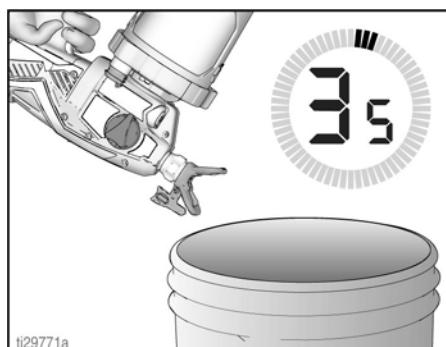
9. 将填料泵 / 喷涂旋钮向前调整至喷涂位
