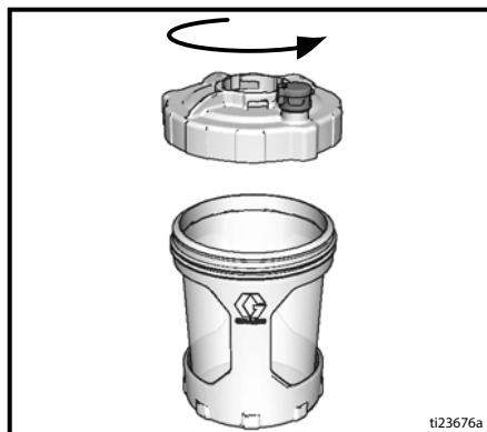
3. 确保 FlexLiner 在涂料杯支承件中。
