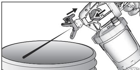
5. 将填料泵 / 喷涂旋钮调低至“填料”位置。将喷嘴回旋至“喷涂”位置。将填料泵 / 喷涂旋钮向前调整至喷涂位置，然后恢复喷涂。
