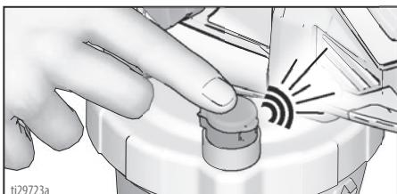
7. 将电池安装到喷涂器上。
