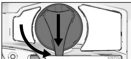
3. 将带有 FlexLiner 的涂料杯支承件从杯罩 / 喷涂机上分离。将喷涂机倒置放在平面上。
