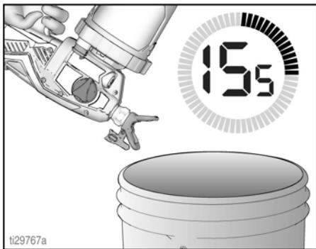
10. 将填料泵 / 喷涂旋钮向前调整至喷涂位置。
