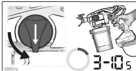
9. 来自填料泵的空气可能在填料期间已进入 FlexLiner。重复步骤 4–6 以确保所有空气都已排出。
