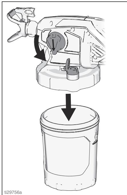
3. 将喷涂机倒置放在平面上。这样湿涂料会保留在杯罩内。将多余的涂料放回至原始容器。倾注时将 FlexLiner 固定在适当的位置上。
