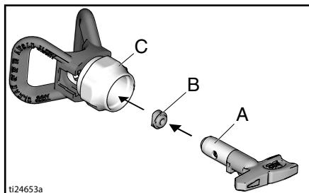
3. 插入喷嘴。喷嘴必须完全压入护罩中。
