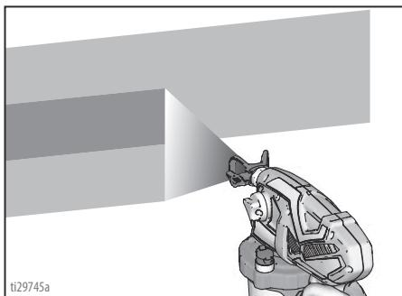
转动喷嘴护罩，可将喷型改为垂直或水平方向。
