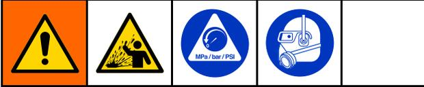
Cet équipement restera sous pression tant que la pression n'a pas été évacuée manuellement. Pour éviter des blessures graves provoquées par du fluide sous pression, comme des éclaboussures, suivez la Procédure de décompression lorsque vous arrêtez la pulvérisation et avant un nettoyage, une vérification ou un entretien de l'équipement.
