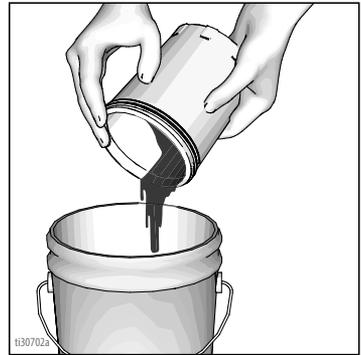
5. 建议废弃已使用过的 FlexLiner (4)，并安装一个新的 FlexLiner。如果重复使用，请擦干净从 FlexLiner (4) 上溢出的液体。
