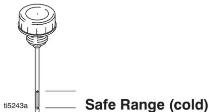
6. Verifique o nível de óleo no compressor. **NOTA:** Se o ponto vermelho estiver visível, adicione óleo do compressor do ar sem detergente SAE 30W.
