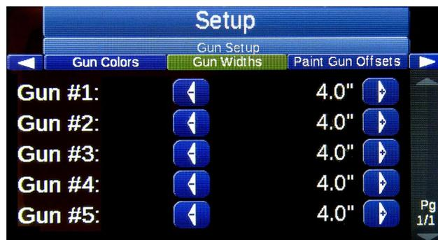
Réglez les largeurs entre les pistolets pour qu'elles correspondent à la largeur d'application réelle du produit sur la route. Un bon réglage des largeurs entre les pistolets est important pour la précision des calculs de l'épaisseur de grammage, l'enregistrement des données et l'impression de rapports.
