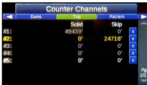
Les canaux de compteur de déclenchement fonctionnent comme un odomètre sur les véhicules. Vous pouvez effacer un compteur de déclenchement de manière individuelle, cependant les compteurs de pistolet classiques resteront inchangés, ce qui permettra de conserver vos mesures de travail et taux d'application. Cette fonction peut s'avérer utile pour le suivi d'une sous-partie d'une tâche.
