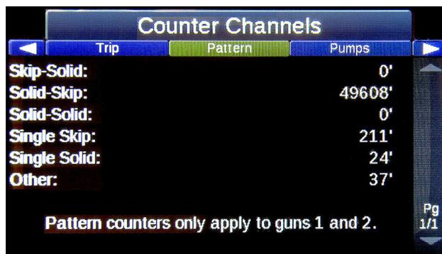
Le canal de compteur de jet suivra différents jets pulvérisés à l'aide de l'interrupteur du pistolet 1 et de l'interrupteur du pistolet 2 uniquement. Cette fonction peut s'avérer utile pour les professionnels qui facturent les travaux en fonction de la distance du jet.
