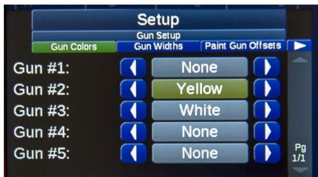
Réglez la couleur de chaque pistolet. Un bon réglage de la couleur est important pour la précision des calculs de l'épaisseur de grammage, l'enregistrement des données, l'impression de rapports et l'aperçu du jet sur l'écran principal.
