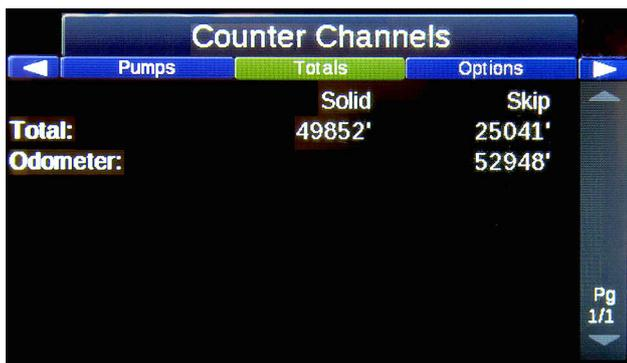
Le canal du compteur des totaux effectuera le suivi de la distance totale de la ligne continue pulvérisée, de la distance totale du saut de trait pulvérisé et de la distance totale de l'odomètre enregistrée.
