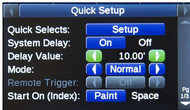
Lorsque le décalage système est ACTIVÉ, tous les interrupteurs de pistolet y compris le MAINTENIR/ RÉINITIALISER seront décalés selon la distance saisie dans le décalage système.
