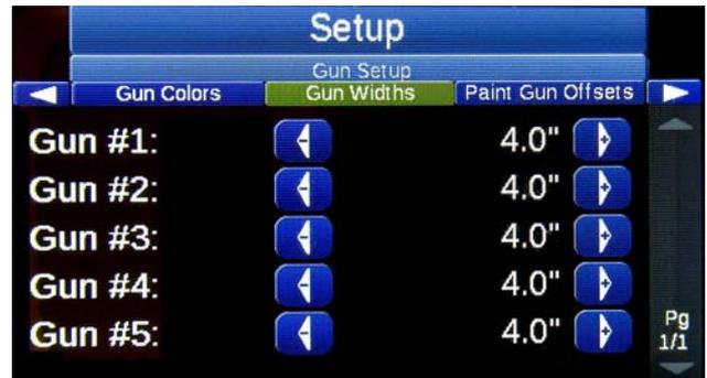
Ajuste la anchura de la pistola para que coincida con el ancho real de la aplicación del material en la carretera. Configurar correctamente la anchura de la pistola es importante para obtener precisión en los cálculos de grosor, el registro de datos y la impresión de informes.
