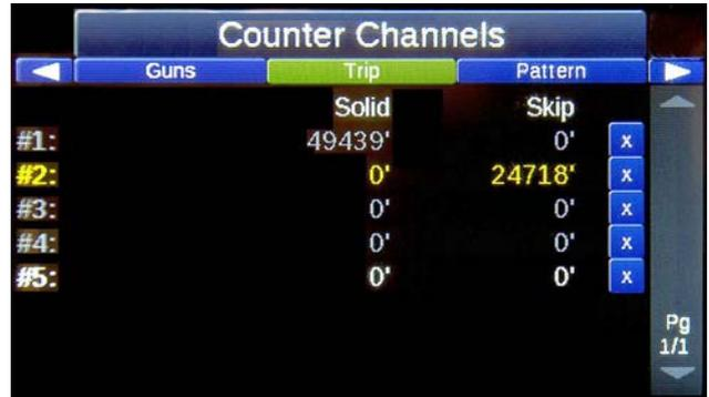
Los canales de contador de recorrido funcionan como el cuentakilómetros de un vehículo. Puede borrar cada contador de recorrido individualmente, pero los contadores de la pistola habitual permanecerán intactos para conservar el recorrido y las tasas de aplicación de su trabajo. Esta función puede ser útil para el seguimiento de una subdivisión de un trabajo.
