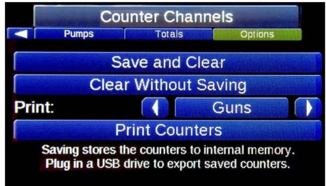
Este Controlador Skipline tiene capacidad de registrar los datos, los cuales se pueden extraer una unidad de almacenamiento externo USB o imprimirse.
