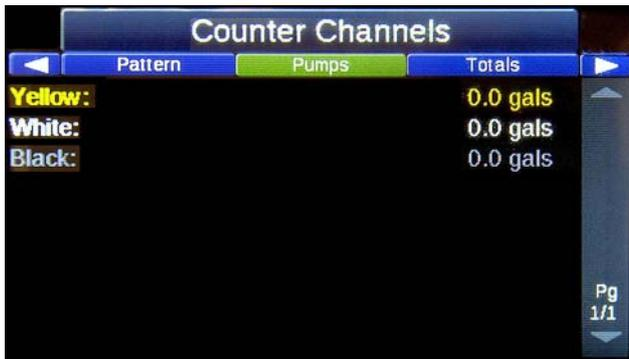
El canal de contador de bomba realiza un seguimiento de los galones bombeados por cada color. Las bombas deben de configurarse con el color correcto en el menú de Configuración/Sistema/Bomba.
