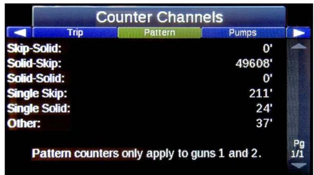
El canal del contador de patrón rastreará los diferentes patrones que se pulverizan con el interruptor de la pistola 1 y el interruptor de la pistola 2 solamente. Esta función puede ser de gran utilidad para los contratistas que facturan los trabajos por distancia de patrón.
