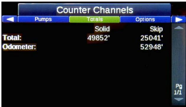
El canal del contador de los totales registrará la distancia total de línea continua pulverizada, la distancia total de línea discontinua pulverizada y la distancia total registrada en el cuentakilómetros.
