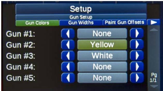
Determine el color para cada pistola. Configurar correctamente el color es importante para obtener precisión en los cálculos de grosor, el registro de datos, la impresión de informes y la vista previa del patrón en la ventana principal.
