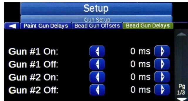
Las desviaciones de la pistola contabilizan los retardos de distancia al marcar el patrón. Ajuste las desviaciones de pistola para todos los elementos en la línea de pistolas.
