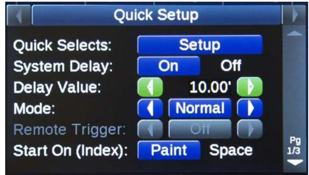
Cuando el retardo del sistema esté en ON (ENCENDIDO), todos los interruptores de pistola incluso el RESET/HOLD (REPOSICIONAR/RETENER) serán retardados la distancia configurada en el retardo del sistema.
