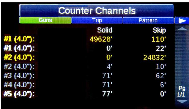
Die Pistolen.-Zählerkanäle erlauben dem Benutzer, Breiten- und/oder Farbänderungen individuell für jede Pistole aufzuzeichnen: Dies sorgt für bessere Aufzeichnungen und Auftragsverfolgung. Zählerkanäle werden sich dynamisch ausgefüllt, nachdem einer Pistole der Abstand zugeordnet wurde. Pistolen, die nicht benutzt wurden, erscheinen nicht auf dem Bildschirm.
