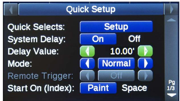
Wenn die Systemverzögerung eingeschaltet ist, werden alle Pistolenschalter einschließlich HOLD/RESET um den in der Systemverzögerung eingestellten Abstand verzögert.
