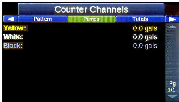
Der Pumpenzähler-Kanal verfolgt die Gallonen, die für jede Farbe gepumpt werden. Pumpen müssen im Menü Setup/System/Pumpen-Setup mit der richtigen Farbe eingerichtet werden.
