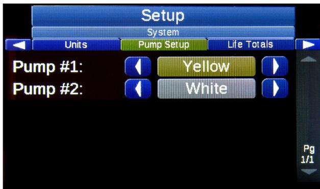
Eingeben, welche Farbe für die Einrichtung jeder Pumpe verwendet wird. Das ist für die richtige Datenprotokollierung für die gepumpten Gallonen notwendig.
