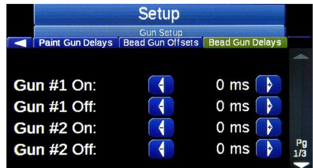
Pistolenverzögerungen korrigieren die mechanische Ansprechverzögerung der Pistole. Die meisten Materialapplikatoren haben eine Zeitverzögerung zwischen dem Zeitpunkt, an dem das elektrische Signal vom Aussetz-Timer anliegt, bis zum Zeitpunkt, an dem die Pistole tatsächlich öffnet und Material fließen kann.
