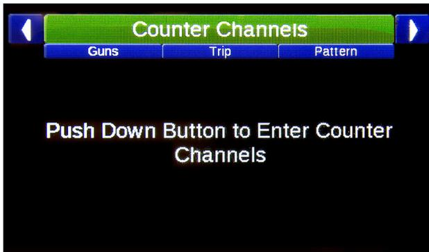
Mit dem Joystick die folgenden Zählerkanäle-Seiten aufrufen: Pistolen, Fehler, Spritzbilder, Pumpen, Gesamtmengen und Optionen.
