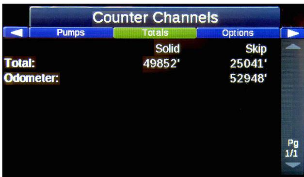
O canal de contador de totais irá monitorizar a distância total da linha contínua pintada, a distância total da linha descontínua pintada e a distância total do odómetro registada.
