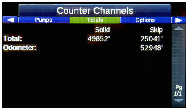
Канал сводной информации отслеживает общую длину нанесенной сплошной полосы, общую длину нанесенной прерывистой линии и записанный общий пробег по одометру.
