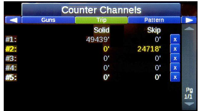
Каналы счетчиков пройденной дистанции действуют как счетчик пробега на автомобилях. Вы можете обнулить любой счетчик пройденной дистанции отдельно. Это не повлияет на обычные счетчики, в которых хранится пробег и дозирование выполняемой задачи. Данная функция может быть полезна для отслеживания подраздела задачи.
