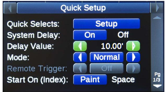
Когда задержка системы включена, она будет действовать с учетом расстояния, установленного для задержки системы, для всех переключателей пистолетов, включая переключатель RESET/HOLD (СБРОС/ОЖИДАНИЕ).
