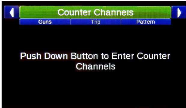
Используйте джойстик, чтобы перейти на страницы каналов счетчиков: Guns (пистолеты), Trip (пройденная дистанция), Pattern (диаграмма), Pumps (насосы), Totals (всего) и Options (опции).
