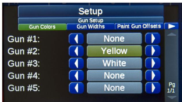
Выбор цвета для каждого пистолета. Правильная настройка цвета важна для точности расчетов толщины (мил), регистрации данных, распечатки отчетов и предварительного просмотра схемы на главном экране.
