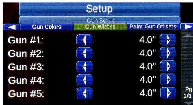
Выберите ширину пистолета, соответствующую фактической ширине нанесения материала на дорогу. Установка правильной ширины пистолета важна для точности толщины нанесения, расчетов, регистрации данных и распечаток отчетов.
