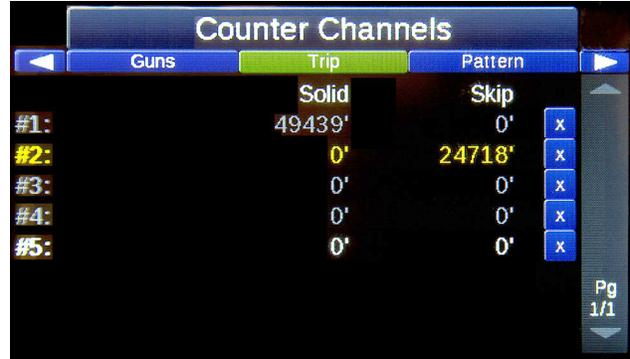
行程计数器通道就像汽车的里程表一样。您可以单独清空任何行程计数器，但常规喷枪计数器将保持完好无损，从而保留您的工作距离和应用率。此功能可能用于跟踪某个工作的子部分。
