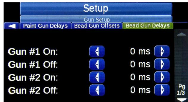
标记图案时，喷枪偏移会造成距离延迟。为喷枪线中的所有物品设置喷枪偏移量。
