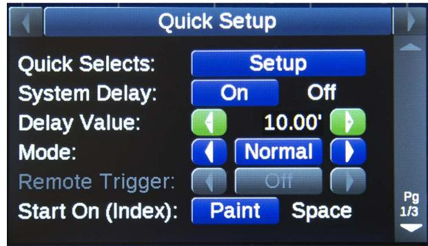
当系统延迟打开时，包括 HOLD / RESET 在内的所有喷枪开关将延迟系统延迟中设置的距离。
