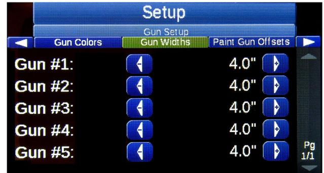
设置喷枪宽度以匹配道路上材料的实际应用宽度。设置适当的喷枪宽度对于密尔厚度、计算、数据记录和报告打印输出的准确性非常重要。
