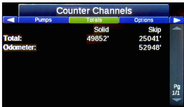
总计计数器通道将跟踪喷涂的实线总距离、喷涂的虚线总距离以及记录的总里程距离。
