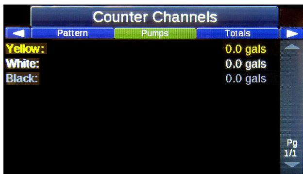
泵计数器通道将跟踪每种颜色泵送的加仑数。必须在设置/系统/泵设置菜单中，使用正确的颜色设置泵。
