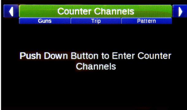
使用操纵杆访问以下计数器通道页面：喷枪、行程、图案、泵、总计和选项。
