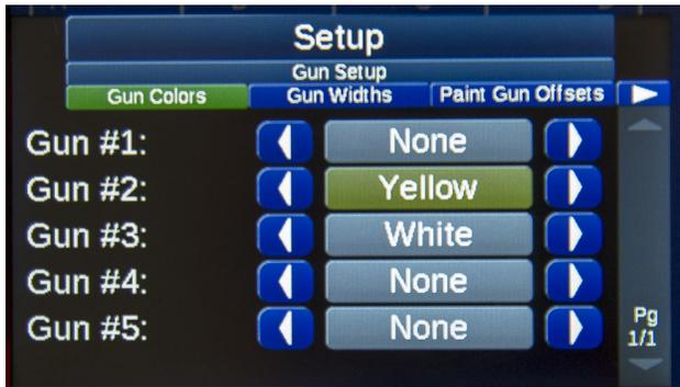
设置每个喷枪的颜色。正确的颜色设置对于密尔厚度计算、数据记录、报告打印输出以及主屏幕上的图案预览的准确性非常重要。
