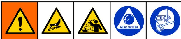
Cet équipement reste sous pression tant que la pression n'a pas été relâchée manuellement. Pour éviter des blessures graves provoquées par du fluide sous pression, comme des injections cutanées ou des éclaboussures dans les yeux ou sur la peau, exécuter la [Procédure de décompression, page 18](#) lorsque le pompage est arrêté et avant un nettoyage, une vérification ou un entretien de l'équipement.
