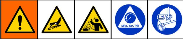
Cet équipement reste sous pression tant que la pression n'a pas été relâchée manuellement. Pour éviter des blessures graves provoquées par du fluide sous pression, comme des injections cutanées ou des éclaboussures dans les yeux ou sur la peau, exécuter la [Procédure de décompression, page 18](#) lorsque le pompage est arrêté et avant un nettoyage, une vérification ou un entretien de l'équipement.
