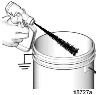
**NOTA:** Si se usa una pistola asistida por aire, aumente la presión de aire girando el regulador de la pistola en sentido de las agujas del reloj.
