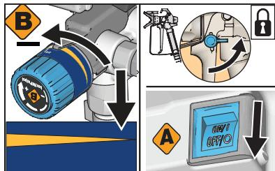
**6** Gire el mando de control de la presión hasta colocarlo en la posición de ajuste más baja y suelte el gatillo. Acople el seguro del gatillo. Mueva la válvula de cebado/pulverización hasta la posición PRIME (Cebado) y el interruptor de encendido en la posición OFF.
