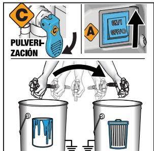
**5** Para ahorrar pintura de la manguera, desenganche el seguro del gatillo y dispare la pistola en un bidón de pintura, gire la válvula de cebado/pulverización hasta la posición SPRAY (Pulverización) y el interruptor de encendido en la posición ON. Cuando salga agua por la pistola, mantenga el gatillo presionado y dirija la pistola hacia el bidón de desechos. Siga purgando la pistola hasta que el agua salga limpia.
