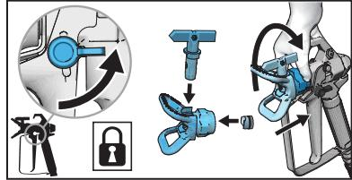
**2** Acople el seguro del gatillo. Asegúrese de que la boquilla de pulverización esté insertada en el protector de boquilla de pulverización, y de que el protector de boquilla de pulverización esté firmemente fijado a la pistola.
