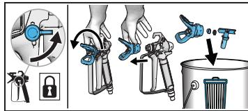
**2** Acople el seguro del gatillo. Desmonte el conjunto de boquilla y protección de la pistola y colóquelo en un bidón de desechos.
