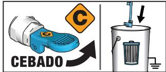
**2** Gire la válvula de cebado/pulverización hasta la posición PRIME (Cebado). Coloque el tubo de drenaje en un bidón de desecho. Coloque la perilla de control de presión a la posición START.
