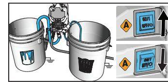
**5** Sumerja el tubo de aspiración en la pintura. Coloque el interruptor de alimentación en la posición ON y controle que la pintura salga por el tubo de drenaje. Coloque el Interruptor de alimentación en la posición de OFF.
