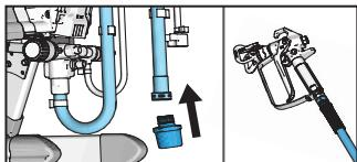
**5** Vuelva a atornillar el filtro de malla al tubo de succión. Asegúrese de que la pistola de pulverización y la manguera permanezcan adheridas al pulverizador.
