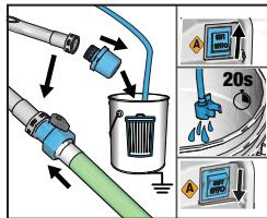
**4** Desensrosque la rejilla de entrada y colóquela en un bidón de desecho. Enrosque el accesorio Lavado Eléctrico en el tubo de aspiración. Abra la válvula de Lavado Eléctrico. Coloque el interruptor de alimentación en la posición de ON y deje que corra el agua por el tubo de drenaje durante 20 segundos. Coloque el interruptor de alimentación en la posición de OFF.
