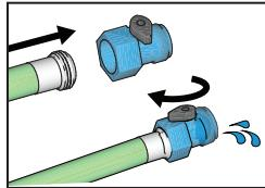
**3** Enrosque el acoplamiento de Lavado Eléctrico (incluido con el pulverizador) en una manguera de jardín. Abra el agua. Abra la válvula de Lavado Eléctrico. Aclare la pintura del tubo de aspiración y drenaje, la pantalla de entrada, y el protector y la boquilla de pulverización. Cierre la válvula de Lavado Eléctrico.
