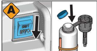
**4** Cuando el Pump Armor fluya a través del pulverizador, coloque el interruptor de encendido en la posición OFF. Sustituya la tapa a prueba de niños y apriétela para almacenarlo.
