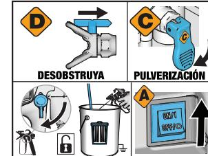
**6** Gire la boquilla de pulverización hacia la posición de UNCLG (Desobstruya). Quite el seguro del gatillo. Apuntando hacia el tubo de desecho, accione y mantenga pulsado el gatillo. Baje la válvula de cebado/pulverización hasta la posición SPRAY (Pulverización) y el interruptor de encendido en la posición ON.
