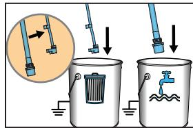
**2** Separe el tubo de drenaje (más pequeño) del tubo de aspiración (más grande). Coloque el tubo de drenaje en el bidón de desecho. Sumerja el tubo de aspiración en un bidón lleno de agua para los materiales con base acuosa o alcohol mineral en caso de que haya material con base oleosa.
