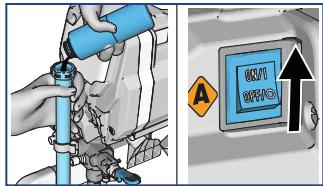
**3** Sujetando el tubo de aspiración por encima del pulverizador, pulverice aproximadamente 2 onzas (1/4 copa) de Pump Armor en el tubo de aspiración y coloque el interruptor en la posición de ON.
