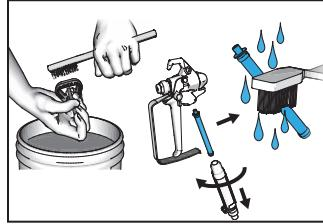
**7** Limpie la boquilla de pulverización, el protector de boquilla de pulverización y la rejilla de entrada con un cepillo. Retire el filtro de la pistola y límpielo. Vuelva a colocar el filtro de la pistola, el protector de boquilla de pulverización y la propia boquilla.
