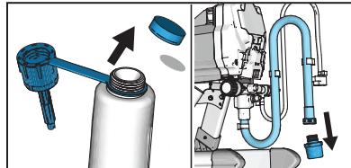
**1** Retire el tapón de la botella de Pump Armor y el sello metálico. En caso de que sea necesario, desenrosque la rejilla de entrada del tubo de aspiración.
