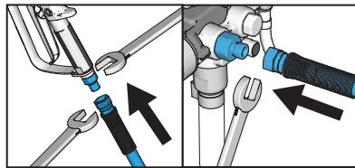
**1** En caso de sea necesario, conecte la manguera a la pistola. Retire la tapa del extremo y conecte la manguera al pulverizador. Apriete firmemente.
