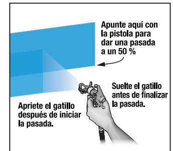
**2** Aumente la presión de la perilla de control en caso de que sea necesario hasta que la pulverización se distribuya uniformemente sin fisuras ni bordes.
