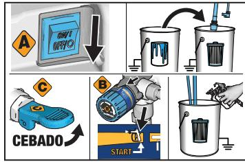
**1** Coloque el interruptor de alimentación en la posición de OFF. Coloque los tubos de aspiración y de drenaje en el bidón de desechos. Gire la válvula de cebado/pulverización hasta la posición PRIME (Cebado). Gire la perilla de control de presión a la posición START. Dispare la pistola en un bidón de desechos.
