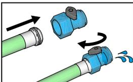
**3** Vissez la vanne de rinçage forcé (y compris le pulvérisateur) sur un tuyau d'arrosage. Ouvrez l'eau. Ouvrez la vanne de rinçage forcé. Rincez les tuyaux d'aspiration et de vidange, la crépine, la buse de pulvérisation et le garde-buse pour éliminer la peinture. Fermez la vanne de rinçage forcé.
