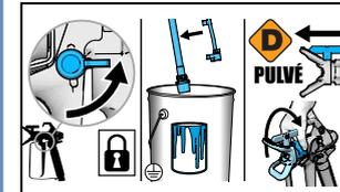
**7** Dès que la peinture commence à s'écouler du pistolet, relâcher la gâchette. Verrouillez la gâchette. Transférez le tuyau de vidange dans le seau de peinture et fixez-le au tuyau d'aspiration. Faites tourner la buse de pulvérisation vers l'arrière pour la mettre en position PULVÉRISATION et assurez-vous que le garde-buse est bien serré.
