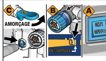
**3** Mettez la vanne d'amorçage/ de pulvérisation en position AMORÇAGE. Appuyez sur le bouton PushPrime\* deux fois pour desserrer la bille de la vanne d'entrée. Tournez le bouton de réglage de pression en position START (DÉMARRAGE). Mettez l'interrupteur principal sur ON (MARCHÉ).
