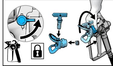
**2** Verrouillez la gâchette. Veillez à ce que la buse de pulvérisation soit correctement insérée dans le garde-buse et que ce dernier soit correctement serré sur le pistolet.
