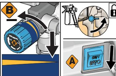
**6** Tournez le bouton de réglage de pression sur le réglage le plus bas et relâchez la gâchette. Verrouillez la gâchette. Mettez la vanne d'amorçage/de pulvérisation sur **AMORÇAGE** et mettez l'interrupteur principal sur **OFF (ARRÊT)**.
