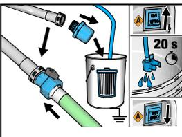
**4** Dévissez la crépine et mettez-la dans le seau à déchets. Vissez la vanne de rinçage forcé sur le tuyau d'aspiration. Ouvrez la vanne de rinçage forcé. Mettez l'interrupteur principal en position **ON (MARCHÉ)** et laissez l'eau s'écouler dans le flexible de vidange pendant 20 secondes. Mettez l'interrupteur principal sur **OFF (ARRÊT)**.
