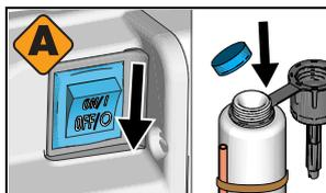
**4** Lorsque le Pump Armor qui se trouve dans le pulvérisateur est rincé, mettez l'interrupteur principal en position **OFF (ARRÊT)**. Remplacez et serrez le capuchon de sécurité pour le stockage.
