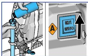
**3** Tout en maintenant le tuyau d'aspiration au-dessus du pulvérisateur, versez environ 60ml (2 onces) de Pump Armor dans le tuyau d'aspiration et mettez l'interrupteur principal en position **ON (MARCHÉ)**.
