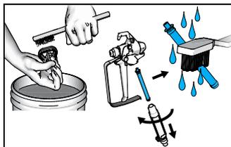
**7** Nettoyez la buse de pulvérisation, le garde-buse et la crépine avec une brosse. Retirez le filtre de pistolet et nettoyez-le. Remontez le filtre de pistolet, la buse et le garde-buse.
