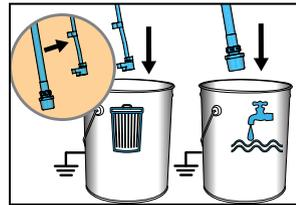
**2** Débranchez le tuyau de vidange (petit) du tuyau d'aspiration (gros). Mettez le tuyau de vidange dans le seau à déchets. Plongez le tuyau d'aspiration dans un seau rempli d'eau si vous pulvérisez un produit à base d'eau ou de white spirit si vous pulvérisez un produit à base d'huile.
