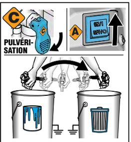
**5** Pour garder de la peinture dans le flexible, déverrouillez la gâchette et actionnez le pistolet dans un seau à déchets, abaissez la vanne d'amorçage/pulvérisation en position **PULVÉRISATION** et mettez l'interrupteur principal en position **ON (MARCHÉ)**. Lorsque l'eau commence à sortir du pistolet, maintenez la gâchette enfoncée et dirigez le pistolet vers l'intérieur du seau à déchets. Continuez à rincer jusqu'à ce que l'eau soit claire.
