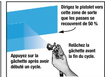
**2** Tournez davantage le bouton de réglage de pression (le cas échéant) jusqu'à ce que la pulvérisation soit uniforme et qu'elle ne présente pas d'espacement au niveau des bordures.
