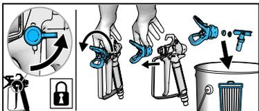
**2** Verrouillez la gâchette. Retirez le garde-buse du pistolet et déposez-le dans le seau à déchets.
