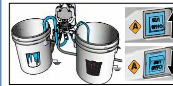
**5** Plongez le tuyau d'aspiration dans la peinture. Mettez l'interrupteur principal en position ON (MARCHÉ) et attendez que la peinture sorte du tuyau de vidange. Mettez l'interrupteur principal en position OFF (ARRÊT).
