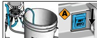
**4** Laissez le liquide s'écouler dans le tuyau d'aspiration et en dehors du tuyau de vidange pendant 30 à 60 secondes. Mettez l'interrupteur principal en position OFF (ARRÊT).
