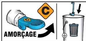
**2** Mettez la vanne d'amorçage/pulvérisation en position d'**AMORÇAGE**. Mettez le tuyau de vidange dans le seau à déchets. Tournez le bouton de réglage de pression en position **START (DÉMARRAGE)**.
