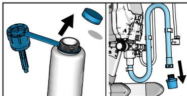
**1** Retirez le capuchon de bouteille de Pump Armor et le joint de feuille. Si nécessaire, dévissez le tamis d'entrée du tuyau d'aspiration.
