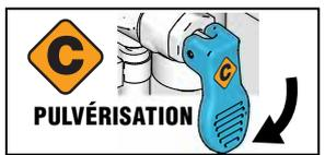
**6** Abaissez la vanne de pulvérisation/pulvérisation en position **PULVÉRISATION** pour le stockage. Mettez l'interrupteur principal en position **OFF (ARRÊT)** et débranchez le pulvérisateur de la prise.
