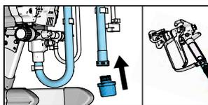
**5** Revissez la crépine sur le tuyau d'aspiration. Assurez-vous que le pistolet et le flexible restent bien attachés au pulvérisateur.
