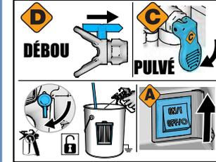
**6** Tournez la buse de pulvérisation en position DÉBOUCHAGE. Déverrouillez la gâchette. Orientez le pistolet dans le seau à déchets, tirez la gâchette et maintenez-la dans cette position. Abaissez la vanne d'amorçage/de pulvérisation en position PULVÉRISATION et mettez l'interrupteur principal sur ON (MARCHÉ).
