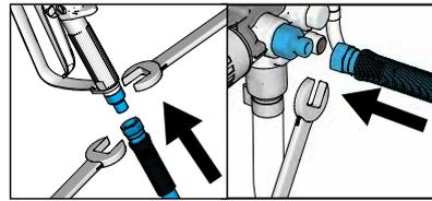
**1** Si nécessaire, branchez le flexible sur le pistolet. Retirez le capuchon rouge, puis branchez le flexible sur le pulvérisateur. Serrez correctement.
