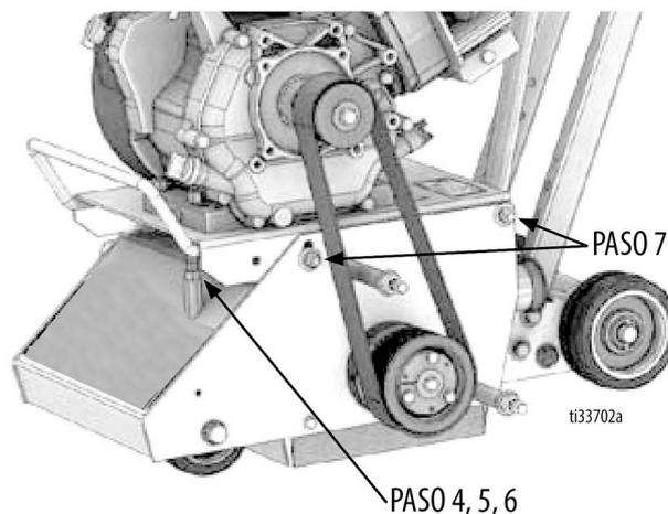
7. Afloje (sin retirarlos) los cuatro pernos (2 por lado) que fijan la placa de montaje del motor al bastidor principal de la máquina.
