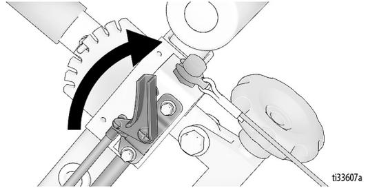
5. **Modelos estándar:** saque la palanca de enganche del cilindro y ajuste a una posición donde el cilindro esté casi tocando el suelo.
