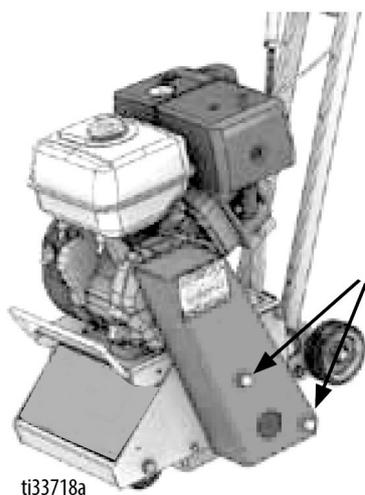
4. Lubrique el tornillo extractor de la placa del motor (tensión de la correa) con lubricante pulverizado en la parte delantera de la máquina.
