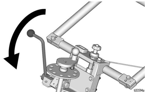
6. **Modelos no DCS:** Gire el mando de ajuste del cilindro (D) hasta que el cilindro entre en contacto con la superficie y se alcance la profundidad deseada.
