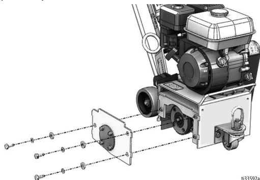
5. Una vez que se retira el cilindro de corte, llévelo a una fábrica para el montaje.
