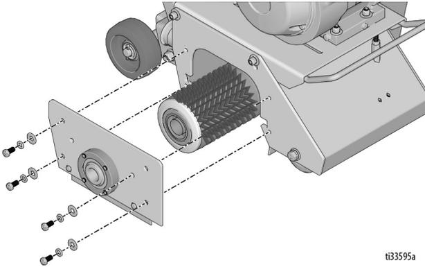
5. Una vez desmontado el cilindro de corte, llévelo a un banco de trabajo para montarlo.
