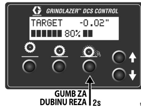
DCS upravljanje sada će biti spremno za brušenje/struganje. Dugo pritišćite preklopku na upravljačkoj ručki kako biste bubanj spustili na ciljanu dubinu reza. Kratko pritisnite gore ili dolje na preklopci kako biste podesili dubinu reza za vrijeme rada. Kada završite rezanje, dugo pritišćite preklopku prema gore kako biste bubanj podignuli u početni položaj.
