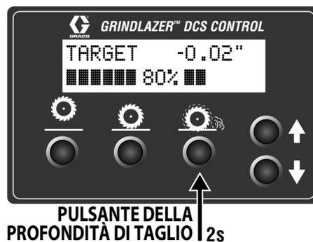
Il Controllo DCS è ora pronto per l'operazione di scarificazione. Premere a lungo l'interruttore basculante "giù" sull'impugnatura a manubrio per abbassare il tamburo fino alla profondità di taglio target. Pressione breve "su" o "giù" dell'interruttore per regolare la profondità di taglio in movimento. Una volta terminato il taglio, pressione prolungata "su" dell'interruttore per sollevare il tamburo nella posizione iniziale.
