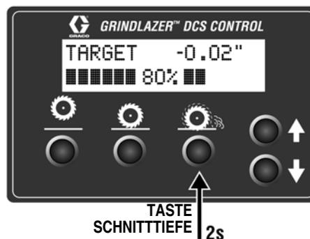
Die DCS-Steuerung ist jetzt bereit zum Fräsen/Entfernen von Linien. Halten Sie den Wippschalter am Handgriff gedrückt, um den Schneidkopf auf sein Soll-Schnitttiefe abzusenken. Drücken Sie den Schalter kurz nach oben oder unten, um Ihre Schnitttiefe im laufenden Betrieb anzupassen. Wenn Sie mit dem Schneiden fertig sind, drücken Sie den Schalter lange nach oben, um den Schneidkopf in die Ausgangsposition zu bringen.
