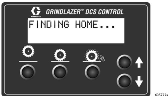
Wenn die DCS-Steuerung die Home-Stellung gefunden hat, stellen Sie sicher, dass das korrekte Modell sowie die gewünschte Sprache und Einheiten ausgewählt sind. Die Anleitung zum Ändern dieser Einstellungen finden Sie in **Menü-Bildschirme**, Seite 16.
