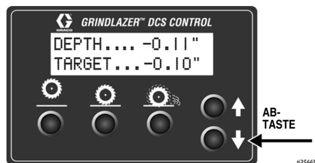
**Langes Drücken:** Der Schneidkopf wird auf die Soll-Schnitttiefe abgesenkt.
