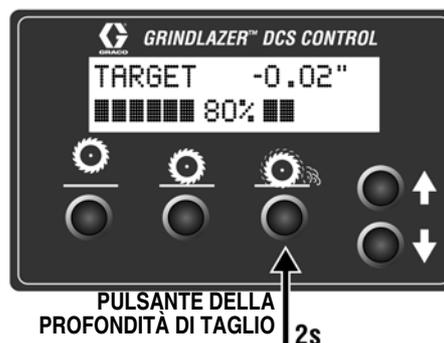
Il Controllo DCS è ora pronto per l'operazione di scarificazione. Premere a lungo "giù" l'interruttore basculante sull'impugnatura a manubrio per abbassare la testa della lama fino alla profondità di taglio target. Pressione breve "su" o "giù" dell'interruttore per regolare la profondità di taglio in movimento. Una volta terminato il taglio, pressione prolungata "su" dell'interruttore per sollevare la testa della lama nella posizione iniziale.
