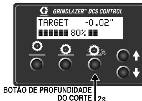
O controle DCS agora está pronto para moer/escarificar. Pressione fixamente o Interruptor de balanço do guidão para abaixar o cabeçote do cortador para o Alvo de profundidade de corte. Pressione rapidamente para cima ou para baixo no interruptor para ajustar sua Profundidade de Corte rapidamente. Quando terminar o corte, pressione fixamente o botão para elevar o cabeçote de corte até a posição inicial.
