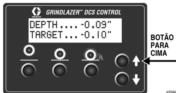
**Pressionar fixamente:** Eleva o cabeçote de corte para a posição inicial.
