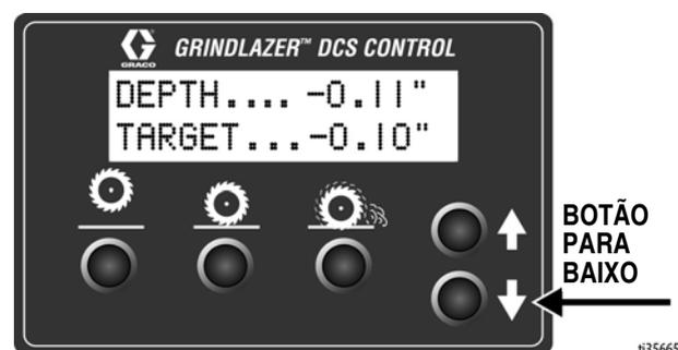
**Pressionar fixamente:** Abaixa o cabeçote de corte para o alvo da Profundidade do Corte.
