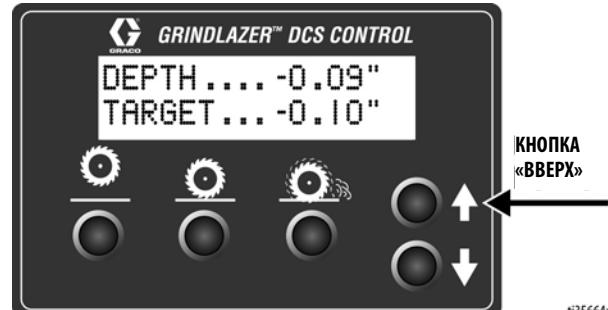
**Долгое нажатие:** Поднимает головку режущего механизма в исходное положение.
